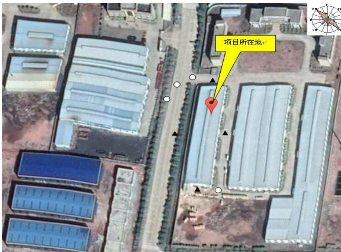
注: “▲”表示噪声监测点; “○”表示无组织废气监测点。
